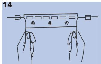
De voorliggende tochtbanden worden geplaatst aan de kant van de achterplaten en met de koppen van de bouten onzichtbaar (fig. 14).
